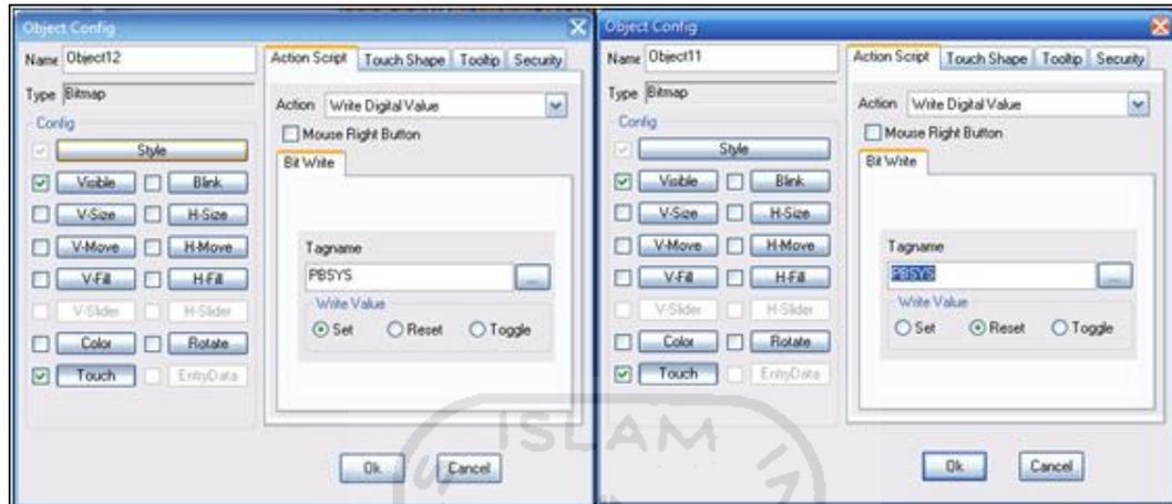
Gambar 3-28 Konfigurasi tombol *on/off*
