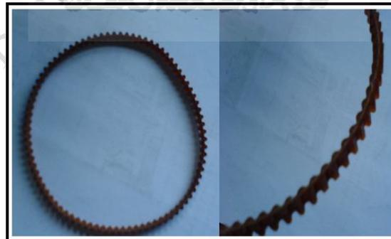
Gambar 3-5 *Belt* penghubung motor
