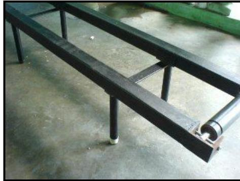
Gambar 3-6 kerangka *conveyor*
