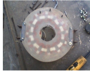
Gambar 8. Stator sebelum dan sesudah di resin
