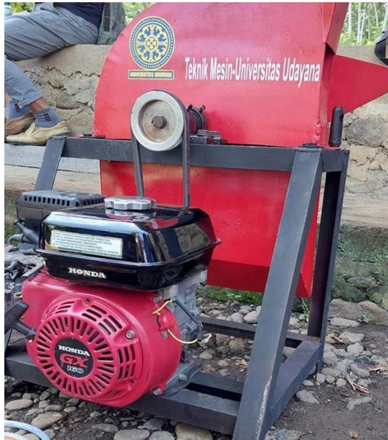
Gambar 3. Mesin crusher kompos berbahan bakar biogas
