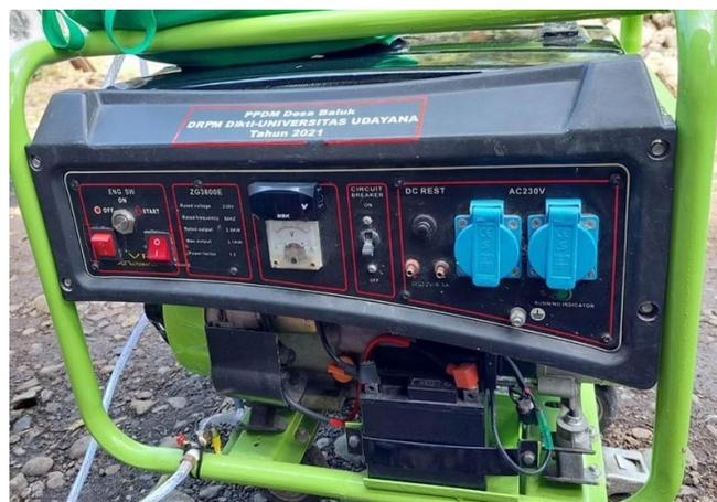
Gambar 4. generator berbahan bakar biogas
