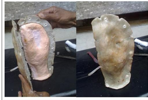
Gambar 4-8 Cetakan silikon dan *backing* yang telah disatukan
