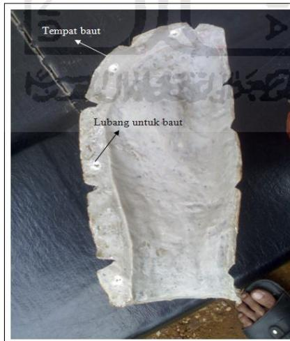
Gambar 4-6 *Backing* cetakan.
