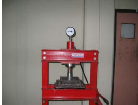
Gambar 4.7. Proses penekanan dengan dongkrak hidrolis
