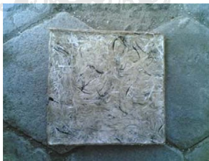
Gambar 4.8. Hasil cetakan setelah digerinda.
