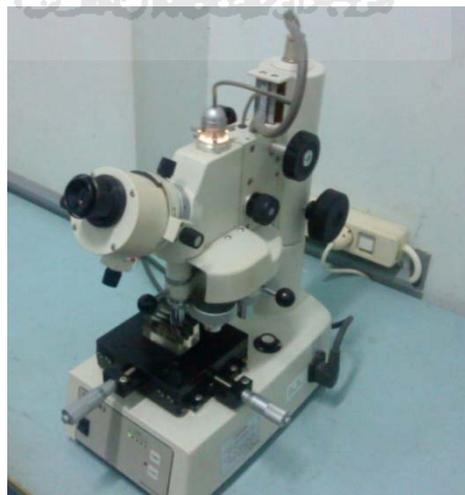
Gambar 3.8. Alat uji mikro vickers
