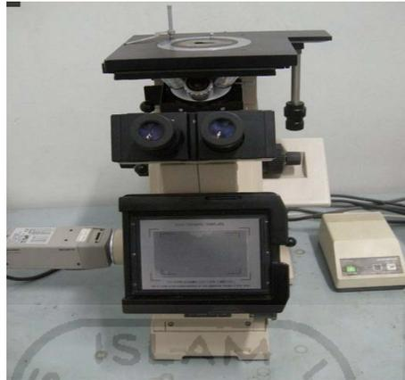
Gambar 3.6. **Alat uji foto mikro**
