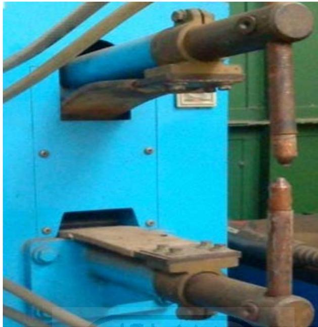
Gambar 3.5. Elektroda atas dan bawah
