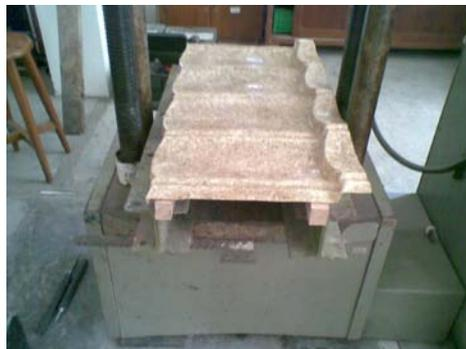
**Gambar 3-18.** Bentuk Genteng Uji 1 lembar x 4 Daun.
