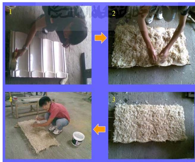
**Gambar 3-6.** (1) Proses Pelapisan Resin, (2, 3) Perataan Bulu Ayam, (4) Penekanan Bulu Ayam dengan Kuas.
