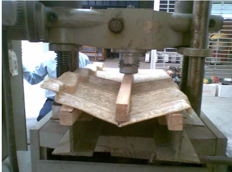
**Gambar 3-22.** *Prototype* Patah Pada Saat Tidak Mampu Lagi Menahan Beban.
