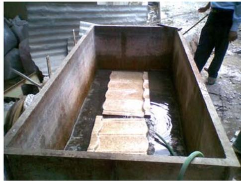
**Gambar 2-12.** Pengujian Daya Serap Air.
