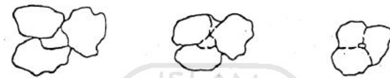
Gambar 2-1 Perubahan bentuk kristal selama Sintering ( www.chem-is-try.org/materi_kimiakimia-industri ) (03/10/2011)
