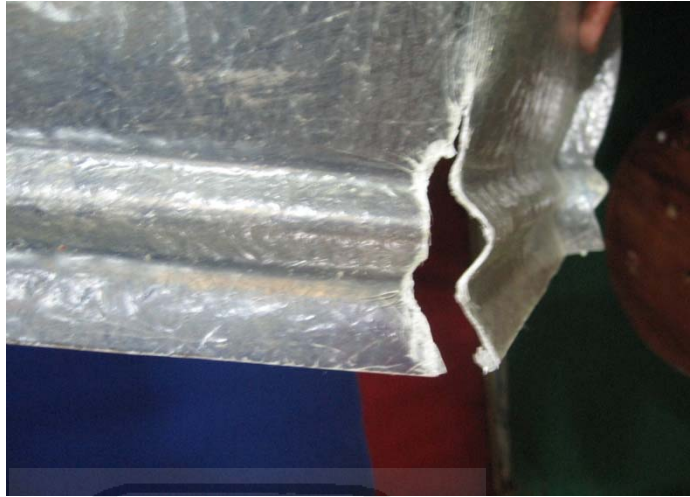
Gambar 35. Patahan genteng fiberglass hasil uji lentur
