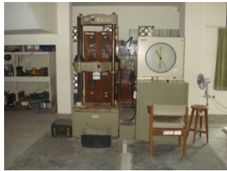
Gambar 24. Alat pengujian lentur
