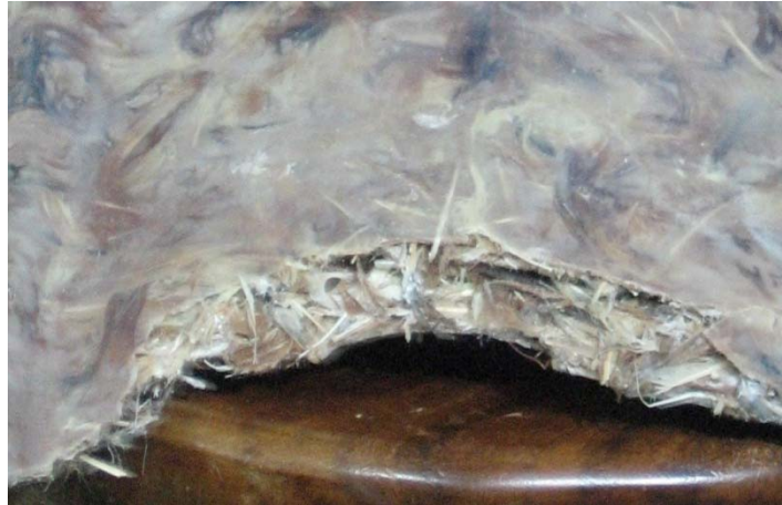
Gambar 34. Patahan genteng hasil uji lentur V_f : 20,99 %
