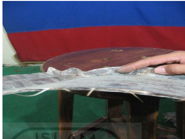
Gambar 33. Patahan genteng hasil uji lentur V_f : 9,3 %
