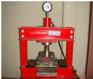
**Gambar 3.13** Proses penekanan dengan dongkrak hidrolik
