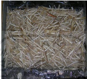
**Gambar 3.12** .Susunan rachis bulu merpati pada cetakan.
