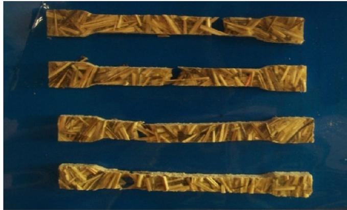
**Gambar 4.8** Patahan komposit dengan variasi  $V_f = 45,21\%$
