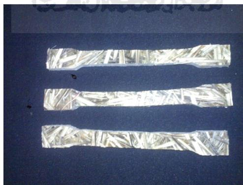
**Gambar 3.15** Spesimen uji tarik
