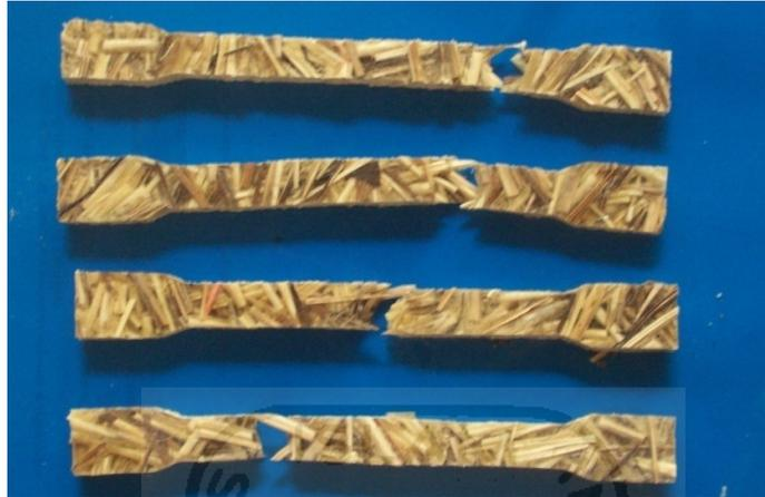
**Gambar 4.6** Patahan komposit dengan variasi  $V_f = 37,49\%$
