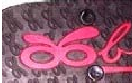
Gambar 4.3 Hasil cetakan emboss sandal karet bahan SR
