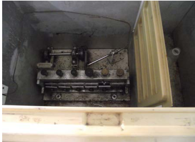
Gambar 3.6 Mesin pengujian kekuatan lentur ( flexing )
