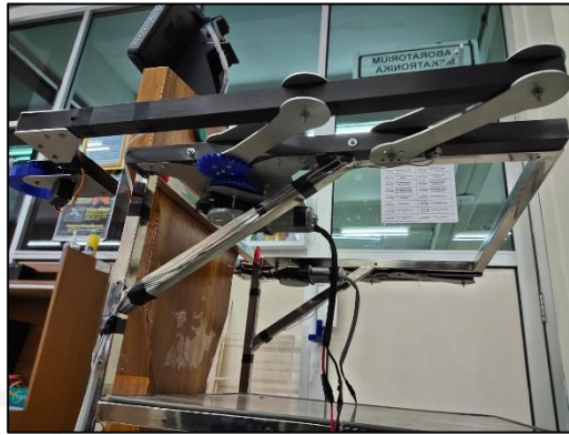
Gambar 4-5 Lengan Mekanisme Pembuka Pintu Tampak Bawah
