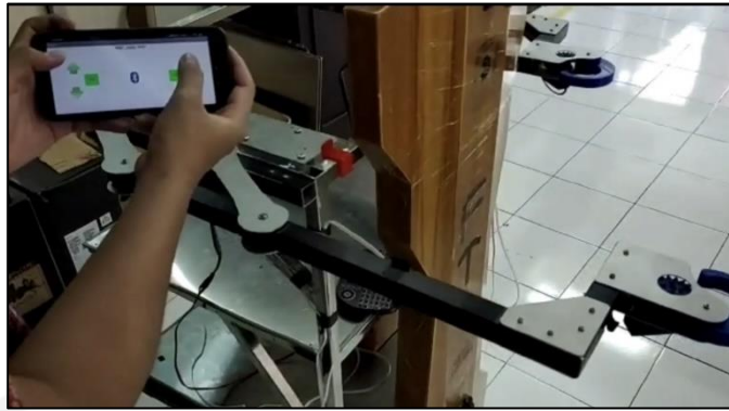
Gambar 4-10 Percobaan Gerakan Lengan Tanpa Beban
