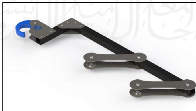
Gambar 3-33 Sub-Assembly Lengan dengan Hook
