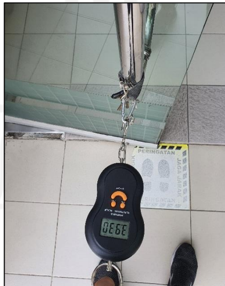
Gambar 3-20 Pengukuran Gaya Tarik Pintu
