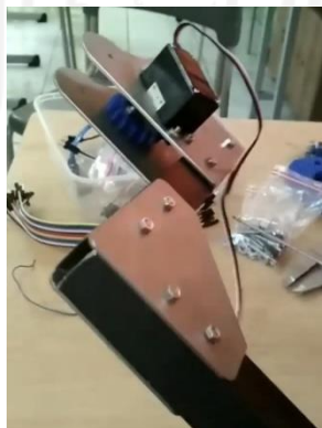
Gambar 3-54 Perakitan Plat Siku Lengan dan Plat Bagian Hook
