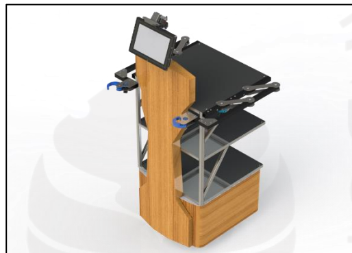
Gambar 4-1 Full Assembly dengan Lengan Posisi Standby
