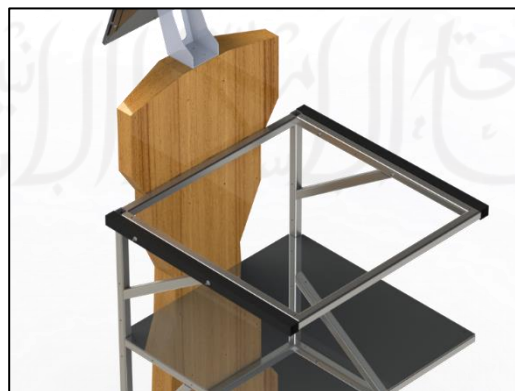
Gambar 3-59 Pemasangan Rangka Hub Badan-Lengan
