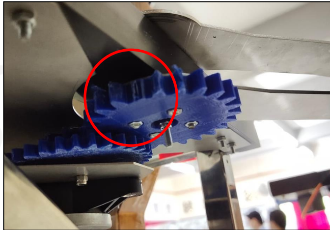
Gambar 4-22 Gear Lengan Rusak
