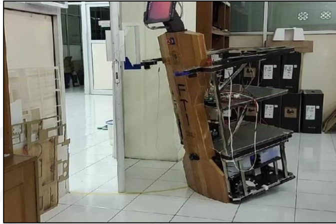
Gambar 4-20 Robot Membuka Pintu dari Dalam Ruangan
