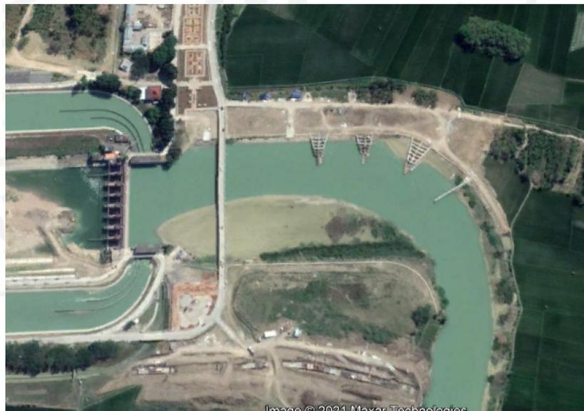
**Gambar 1.1 Deposisi Sedimen Pada Hulu Bendung Klambu**
