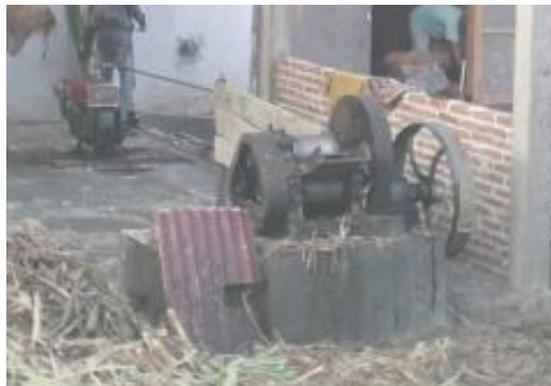
Gambar 4.1 Mesin diesel dan mesin penggiling tebu
