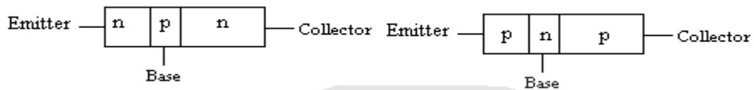
**Gambar 2.3.** ( a ). Konstruksi Transistor pnp dan npn
