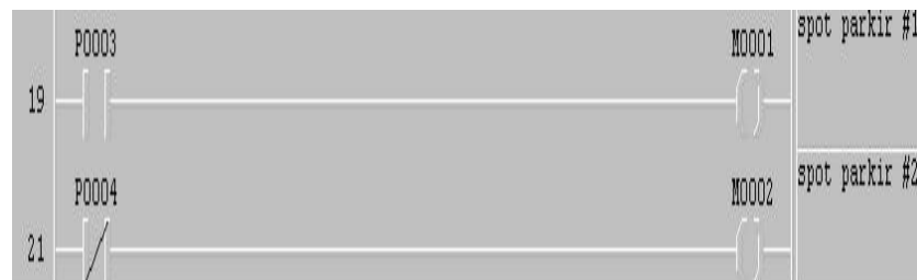
Gambar 2.7. Contoh fungsi Ladder NO, NC dan Output
