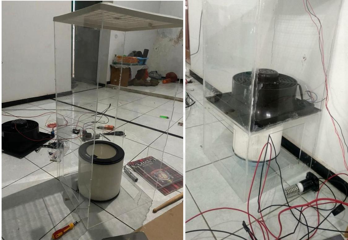
Gambar 1.2 Pemasangan akrilik untuk *casing*
