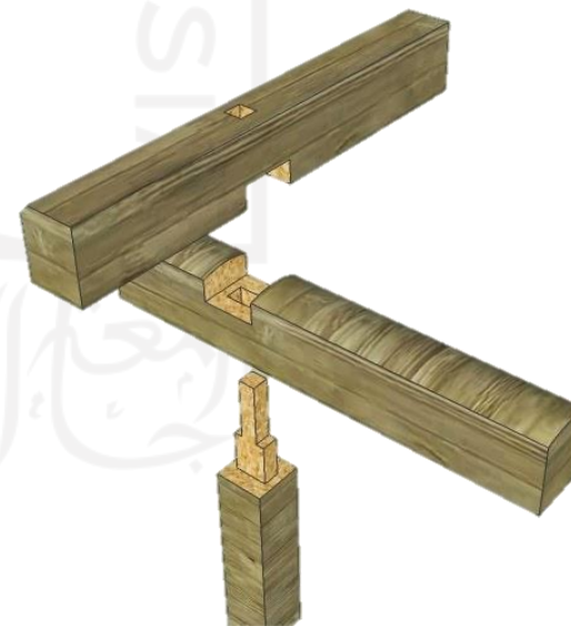
Gambar 35. Sambungan kayu 3 sisi
