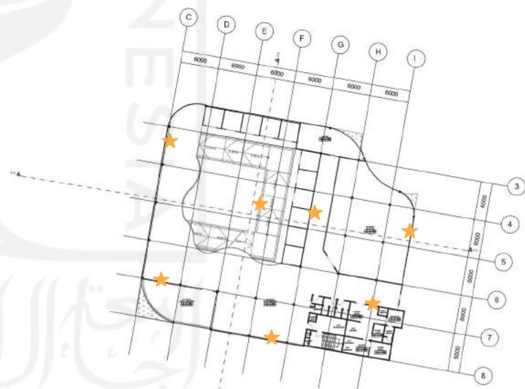
**Gambar 5.43** Peletakan Tanda Dilarang Merokok Lantai Lantai 3
