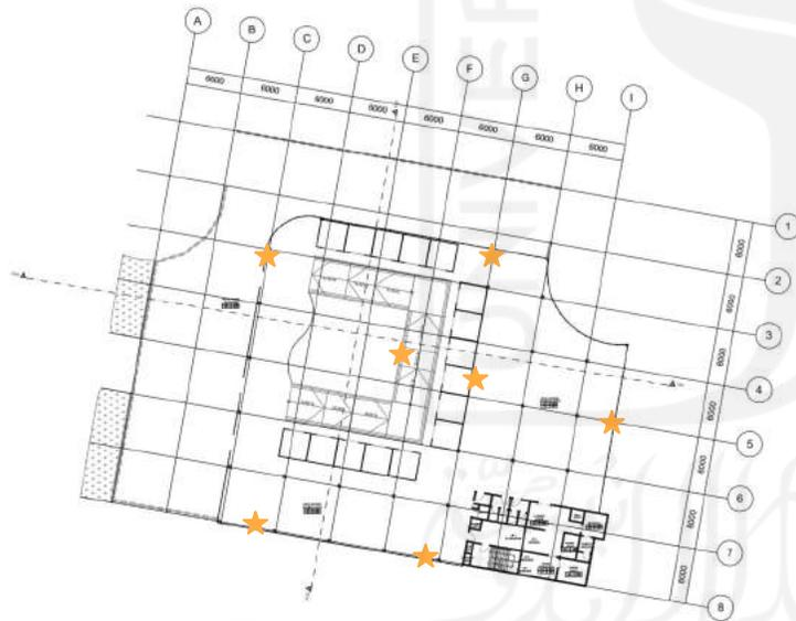
**Gambar 5.42** Peletakan Tanda Dilarang Merokok Lantai Lantai 2
