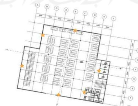
Gambar 5.40 Peletakan Tanda Dilarang Merokok Lantai Basement
