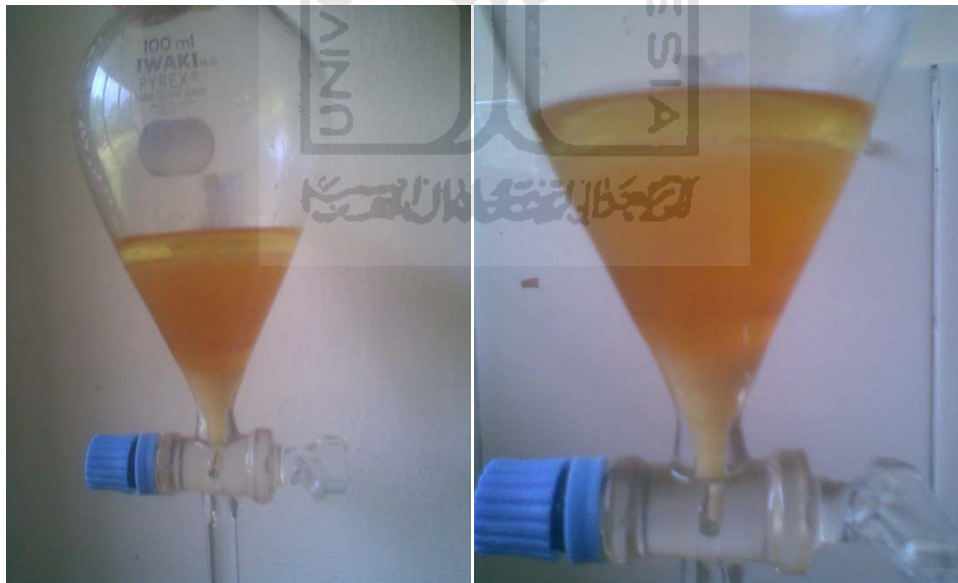
Gambar 13. Hasil transesterifikasi (kiri: terlihat dari jauh, kanan: terlihat dari dekat) membentuk 2 lapisan, terdiri dari lapisan atas adalah metil ester dan lapisan bawah adalah gliserol
