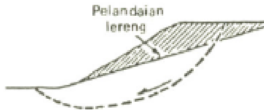
Gambar 3. 2 Tipe Keruntuhan Lereng Gabungan (Sumber: Santoso, 1998)
