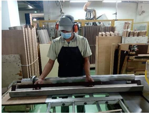
Gambar 4. 5 Proses Pada Mesin Cross Cut
