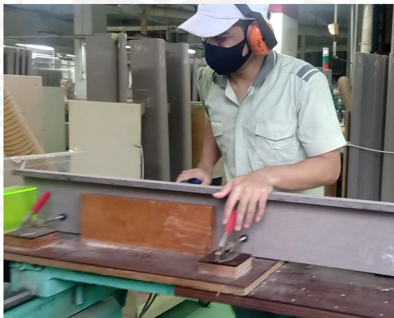
Gambar 4. 10 Proses coak pada mesin Single Tenoner
