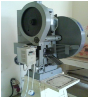
Gambar 28. Alat cetak tablet single punch
