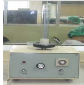
Gambar 23. Alat uji pengetapan
