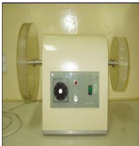
Gambar 26. Alat uji kerapuhan tablet
