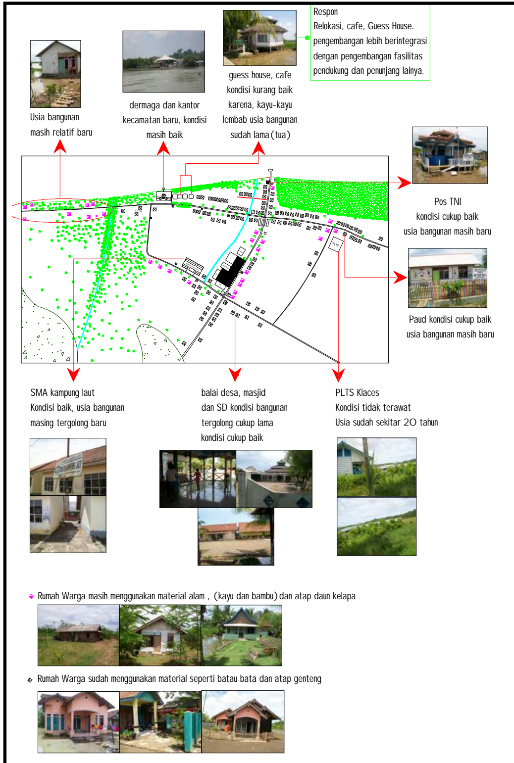
Gambar 5.10. Kondisi bangunan Desa Klaces
