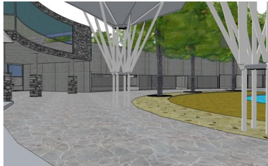
Gambar 3.28. Material batu pecah pada jalan setapak Rest Area
