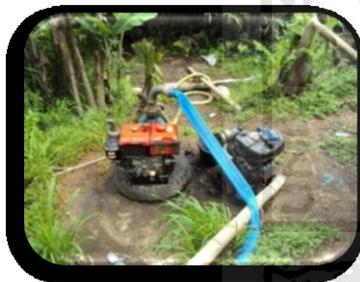
**Tahap 1 :** Air sumber berasal dari air sungai, kemudian dipompa dan di tamping pada bak penampungan yang dinamakan *fastek* untuk mengendapkan kotoran. (gambar 3.2 : pompa air Sumber : survey PMI tanggal 31 januari 2011)
