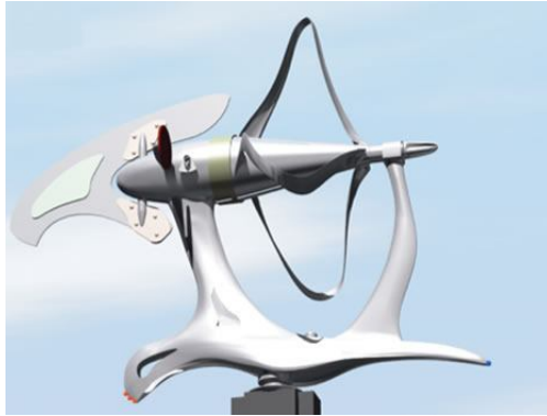
Gambar 3.9. desain kincir Loop Wing
