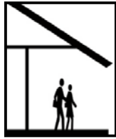
Gambar. 45. Teritisan untuk mencegah air masuk kedalam bangunan
