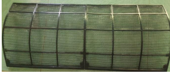
Gambar 4-9 Kondisi Filter Udara Bersih. .
