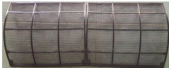
Gambar 4-12 Kondisi Filter Udara Bersih.
