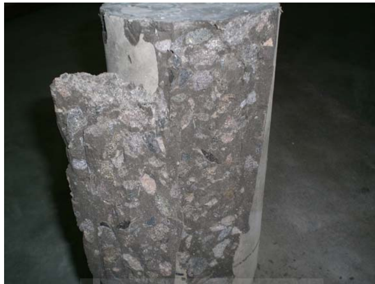
Gambar 5.3 Pecahan Beton Setelah Diuji Desak
