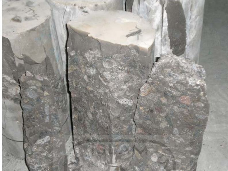
Gambar F.4 Pecahan Benda Uji Setelah Pengujian kuat Desak
