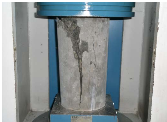
Gambar F.3 Pengujian Kuat Desak Benda Uji
