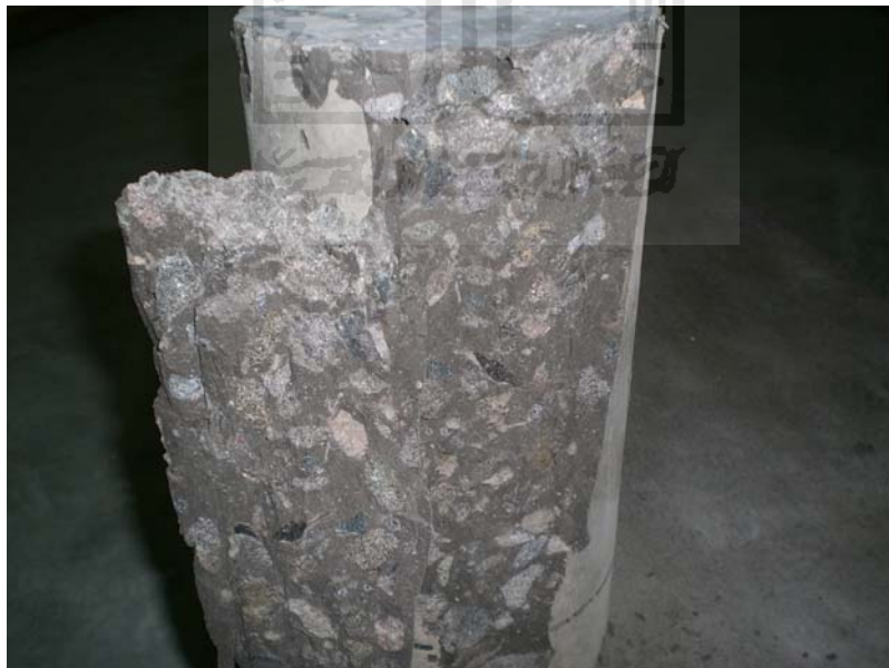
Gambar F.5 Pecahan Benda Uji Setelah Pengujian kuat Desak
