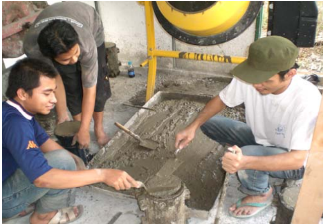
Gambar F.1 Pembuatan Benda Uji Silinder
