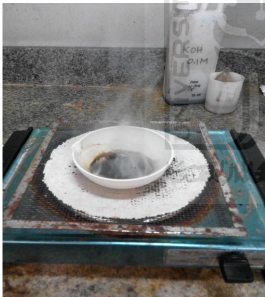
Gambar 9. Proses destruksi limbah oli bekas pada penentuan kandungan logam
