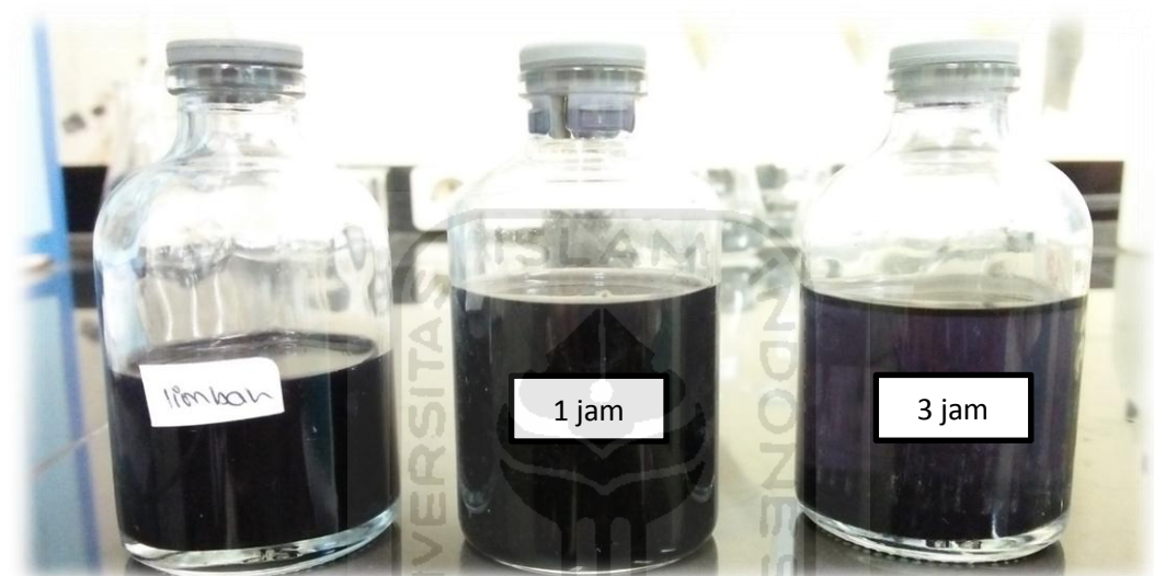
Gambar 16. Perubahan warna degradasi limbah batik (50 mL) pada tegangan 8 Volt dalam \text{NaCl} 0,2 M selama 1 jam dan 3 jam
