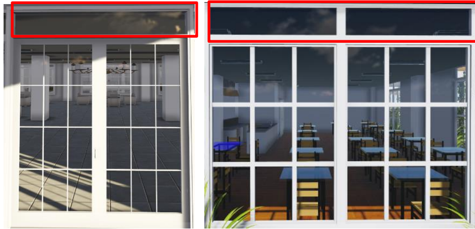
Gambar 3.37 Lubang Angin di Atas Pintu dan Jendela
