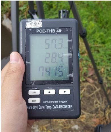
Gambar 7 Thermohygrometer
