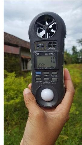
Gambar 8 Anemometer
