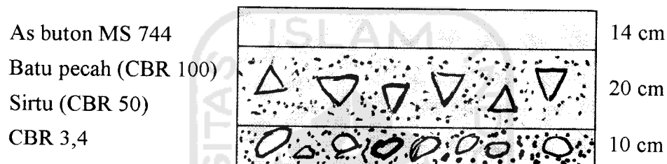
Gambar NO. 5.1. Susunan Perkerasan
