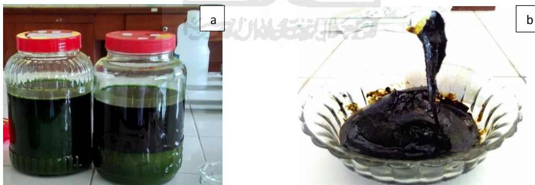
Gambar 4.2 Proses maserasi pembuatan ekstrak etanol daun kangkung darat (a), dan hasil ekstrak kental daun kangkung darat (b).
