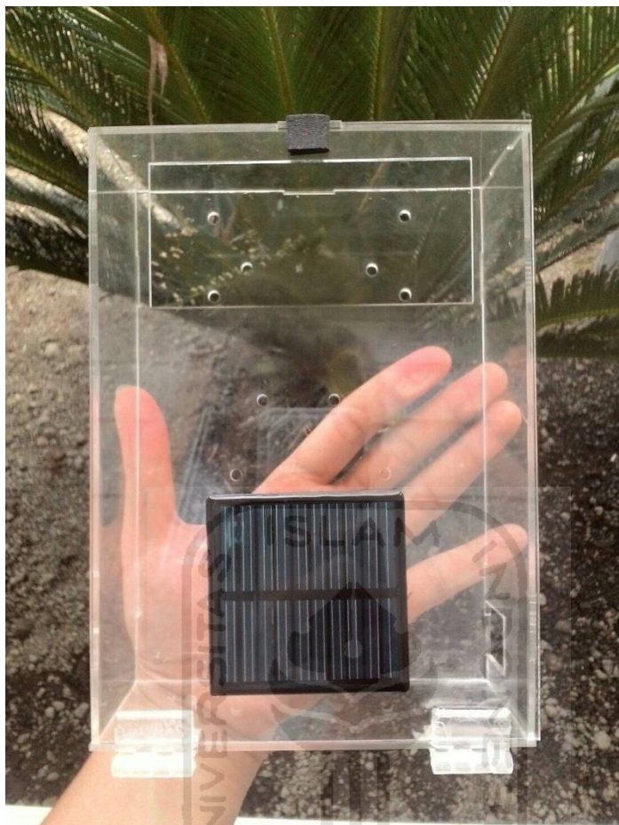
Gambar 3.9 Hasil penempelan dan pembentukan casing alat ukur
