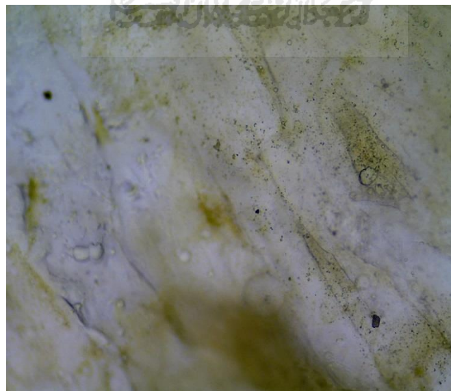
Gambar 4.8 Hasil pengamatan objek uji daging yang sudah diberi denyut tegangan impuls dengan perbesaran 10x
