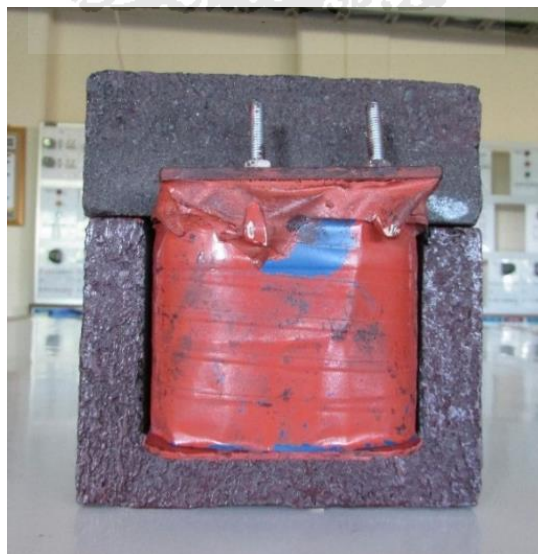
Gambar 3.2 Induktor inti ferit
