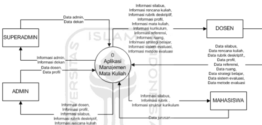
Gambar 4.60 DFD Level 0 Iterasi 3
