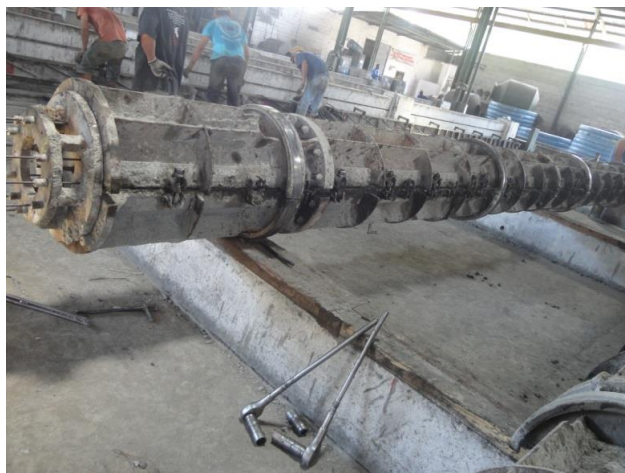
Gambar 4.3 Cetakan tiang listrik
