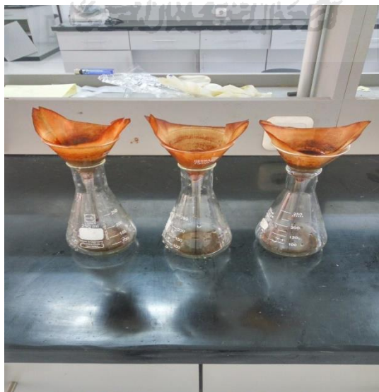
Penyaringan setelah proses hidrolisis
