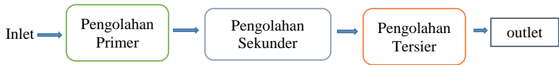
Gambar 3.2 Tahapan Proses Pengolahan Air Limbah
