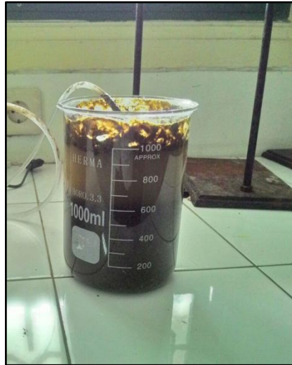
Gambar 3.5 Proses pengolahan secara biologi dengan reaktor Batch
