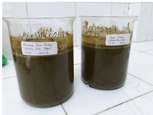
Gambar 3.5 Tahap aktivasi pada adsorben serbuk daun matoa dengan larutan asam sitrat ( C_6H_8O_7 ) 0,1M
