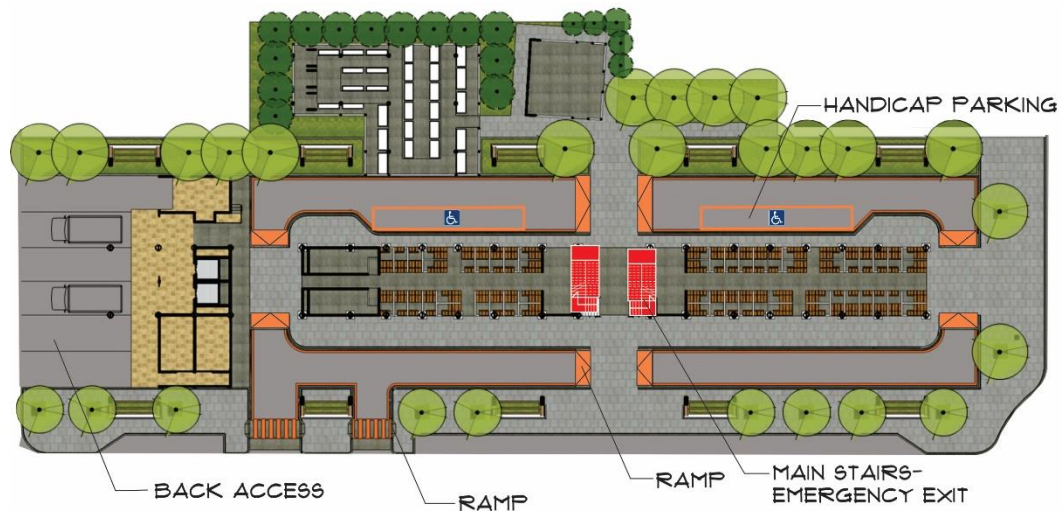
Gambar 4-18. Sistem akses difabel dan keselamatan bangunan
