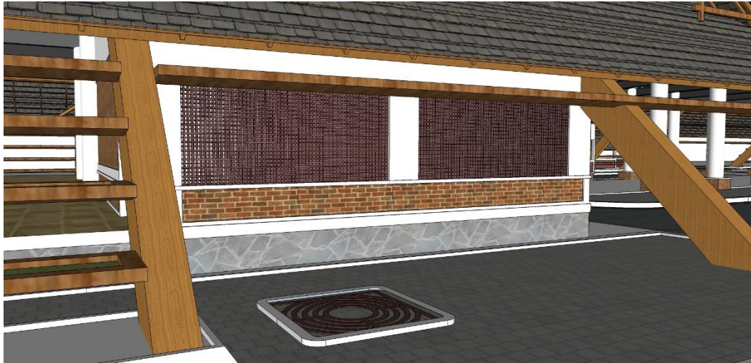
Gambar 4-10. Perspektif selubung bangunan dengan bata berlubang diaplikasikan pada dinding lantai dasar di area service Sumber: Hasil rancangan
