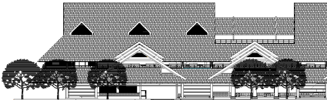
Gambar 5-9. Tampak ventilasi pada sisi barat atap bangunan
