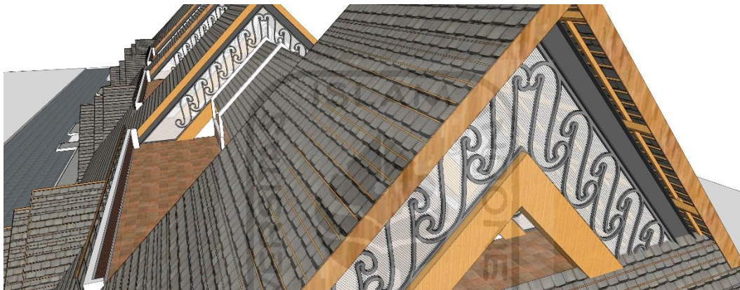
Gambar 4-23. Perspektif kisi-kisi dengan metal perforated sheet pada atap
