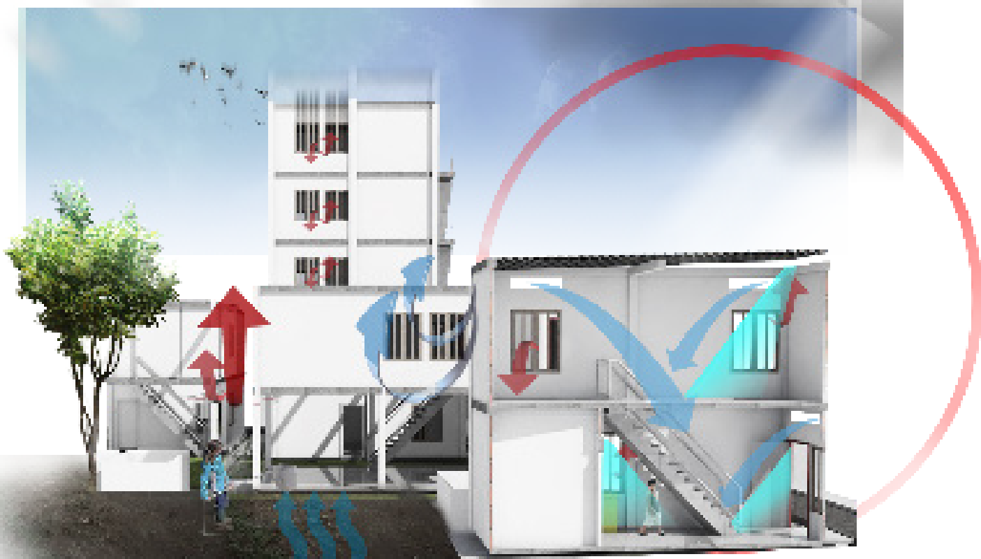
Gambar 4.6 Potongan skematik jalur angin
