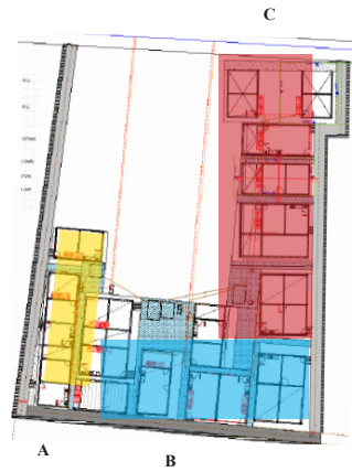
Gambar 4.4 Skema pembagian zona septic tank komunal
