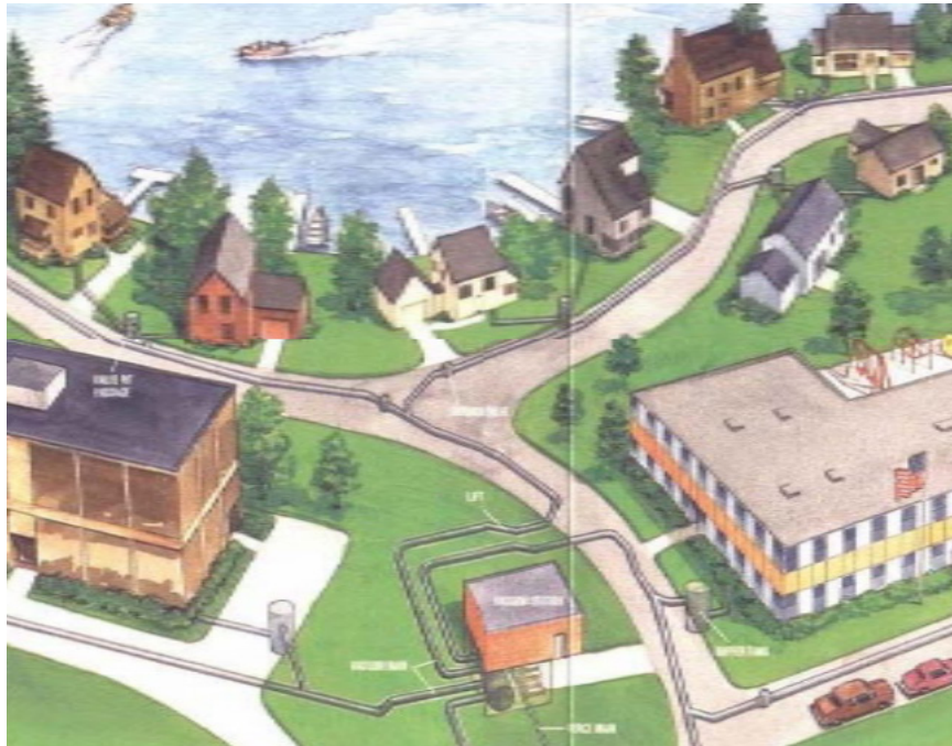
Gambar 2.34 Sistem Sanitasi On Site
