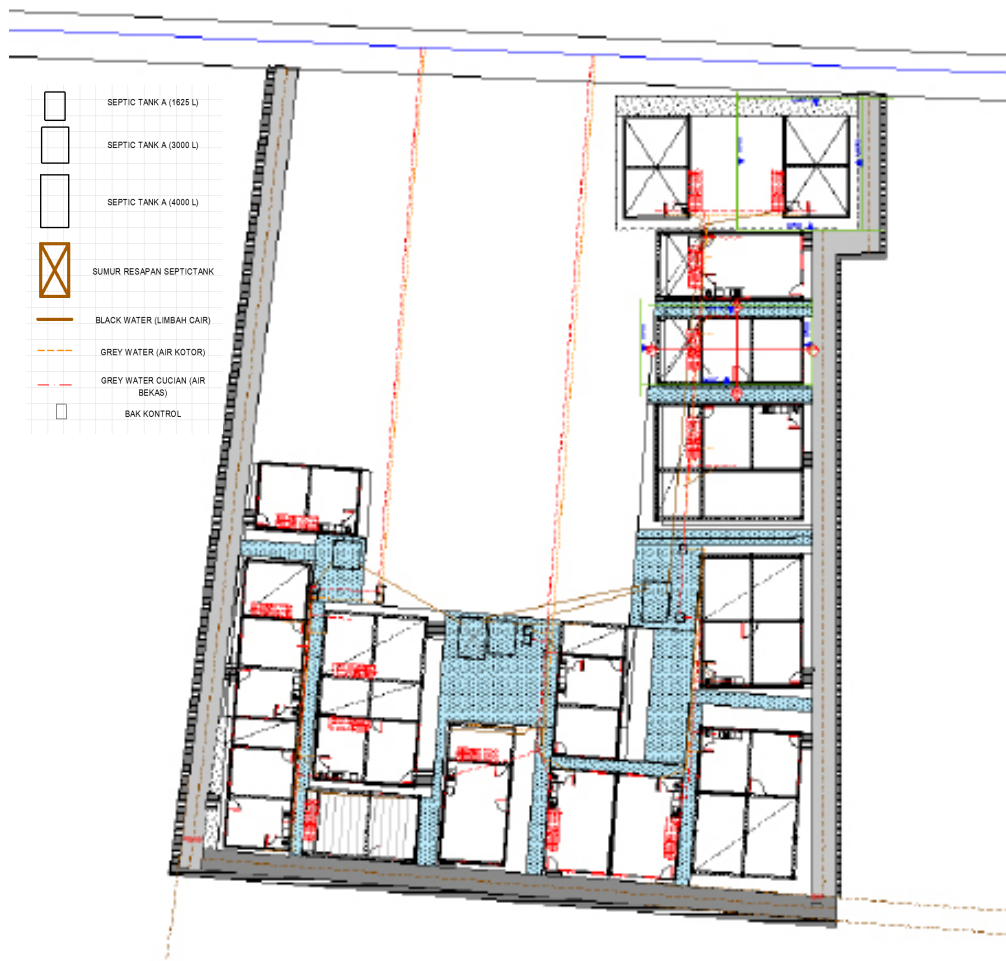
Gambar 4.5 Gambar. Rancangan sistem sanitasi
