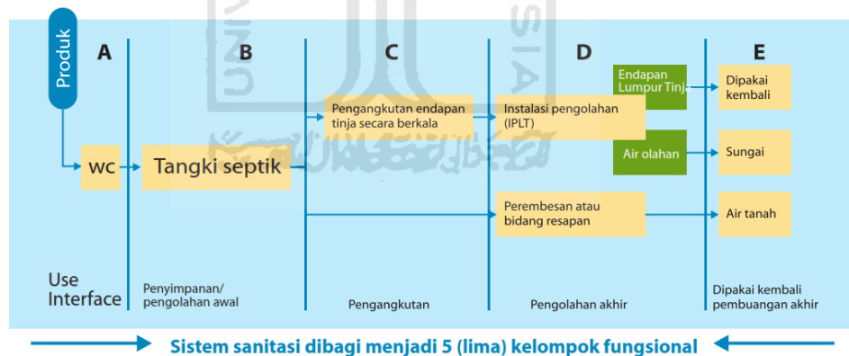
Gambar 2.36 Skema sanitasi secara fungsional
