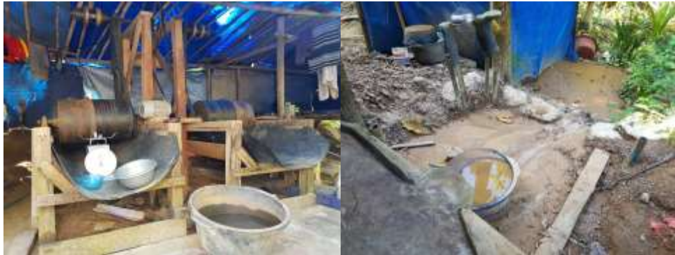
Gambar 4. 1 Pengolahan Bijih Emas dengan Metode Amalgamasi
