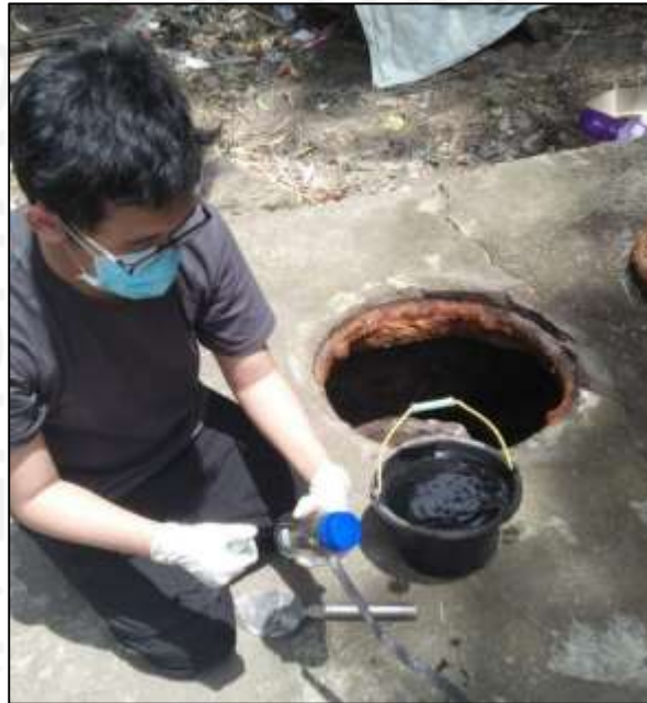
Gambar 15. Pengambilan sampel pada unit pengolah IPAL Wahana Bima Lingkungan
