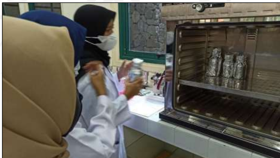
Gambar 14. Sterilisasi alat dengan menggunakan oven pada suhu 105 derajat Celcius
